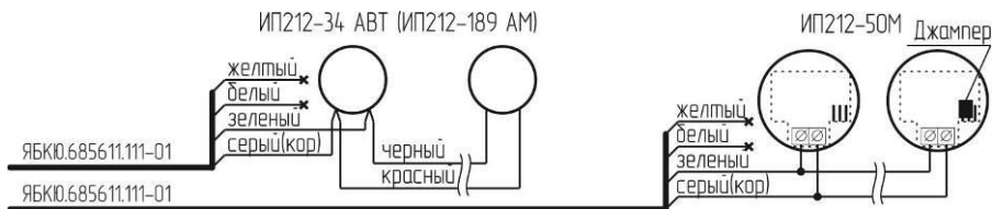
Рисунок Б.3 – Типовая электрическая схема подключения пожарных извещателей
