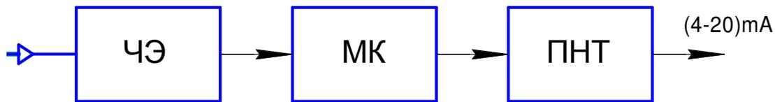
Рис.1 Структурная схема датчика.
