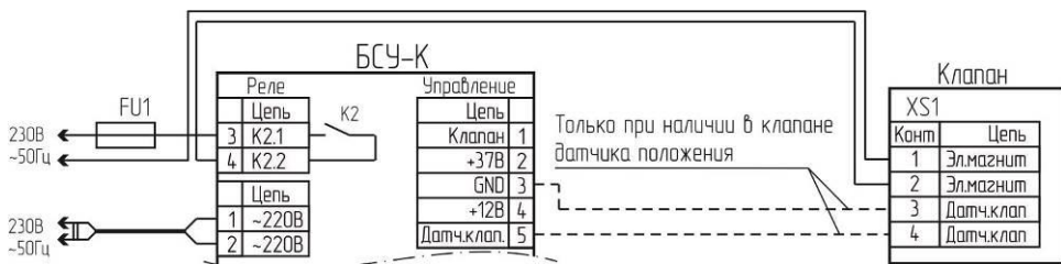
Рисунок Б.9 – Схема подключения клапана типа КПЭГ.
